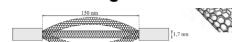
In figuur 3 staat de 'weegschaal' schematisch getekend met de bijbehorende afmetingen in de evenwichtsstand en de uiterste standen van de staande golf. Het buisje trilt met de grondfrequentie van 1,36 GHz. Bepaal de golfnelheid in het nanobuisje.
